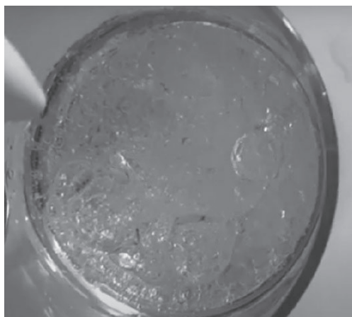
Emulgowanie oleju i wody za pomocą mydła
